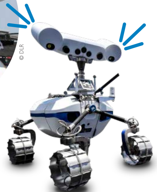
Die letzten Vorbereitungen im Basecamp am Ätna – dann legt Roboter LRU1 los. In seinem Kopf befinden sich mehrere Kamerasysteme. Mit den Filterrädern ganz außen nimmt er zum Beispiel unterschiedliche Frequenzbereiche wahr.
